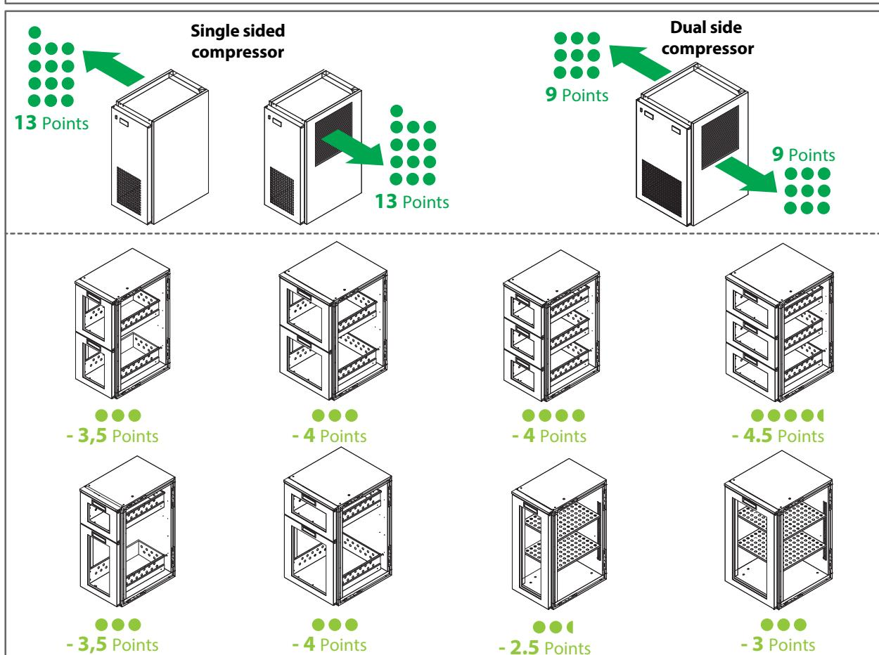
**Con l'unità refrigerante singola possiamo mettere al massimo 3 moduli da 500mm o 4 moduli da 400 mm.**
